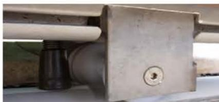
Bremse mit Gummibacke und Führungsrad
